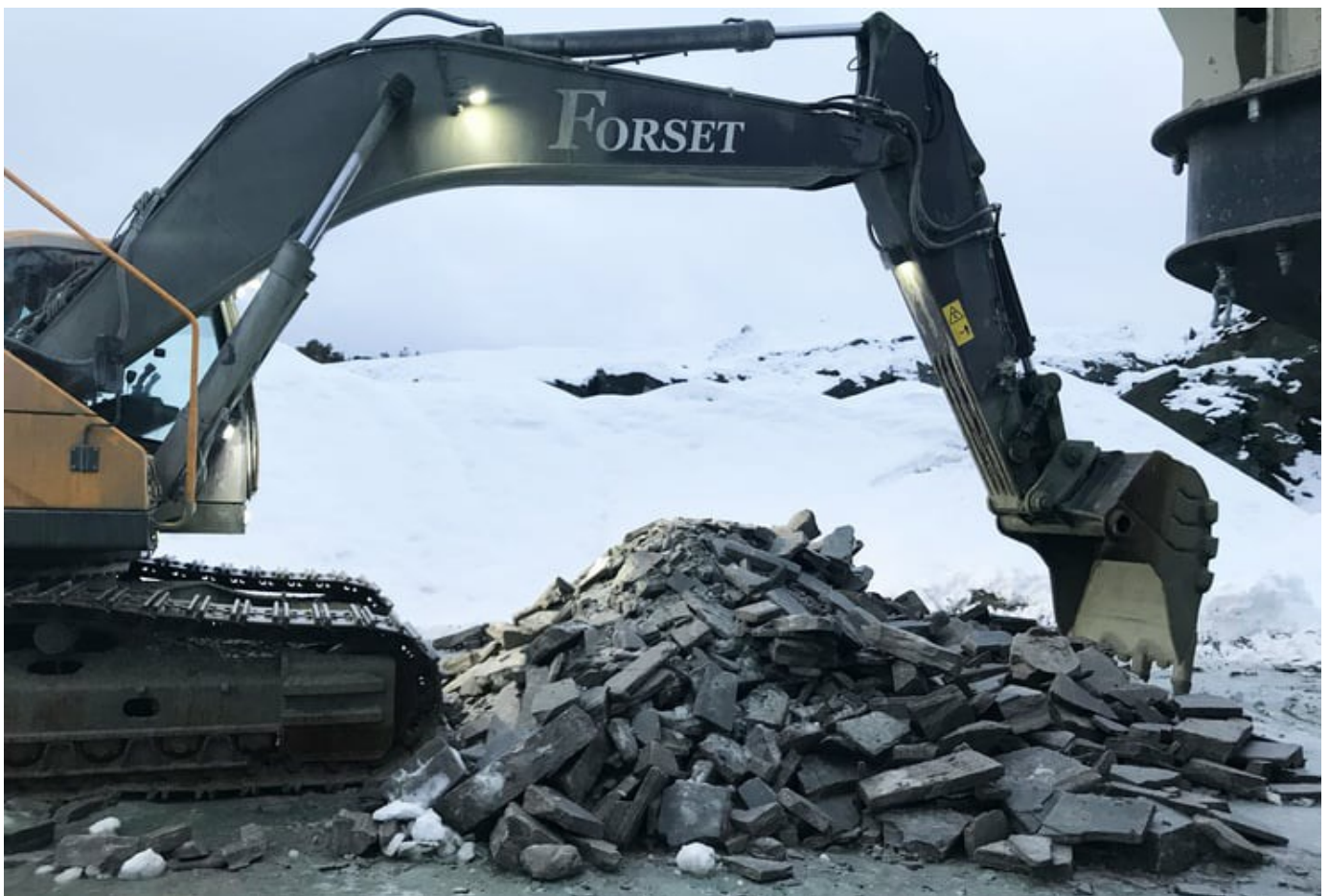
Overskuddsmasse fra skiferproduksjon, klar for prøvekning. Foto: SINTEF
