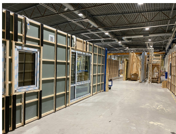
På Frekhaug nord for Bergen prefabrikerer Norske Elementfabrikker veggelementer i tre. Foto: Håkon Kalbakk.
